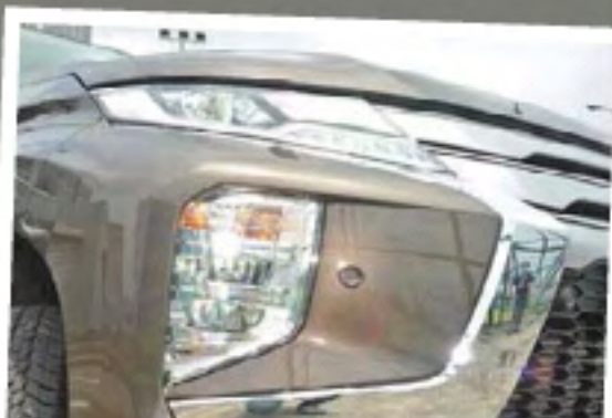
Lampu di bumper kombinasi antara Active Cornering Lamp di tengah, foglamp di bawah dan lampu sein paling atas
