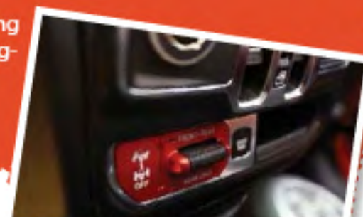
Sistem 4x4 Rock-Trac sudah dilengkapi elektrik differential locker depan dan belakang, bikin jago di medan off-road
