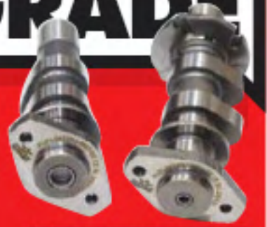
Noken as menggunakan BRT R1 yang menekan klep berdiameter 26 dan 23 mm
