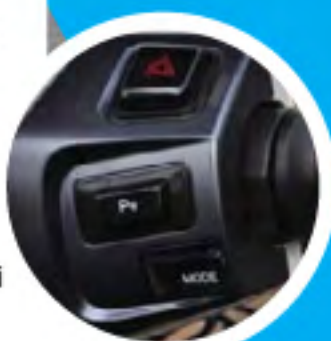
Mengganti riding mode dan mengaktifkan Q-Park Assist lewat tombol di setang kanan
