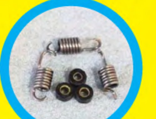
Karet damper racikan RI Matic Shop & Service di lengkapi bushing di bagian tengah, jadi lebih kuat dengan per sentri yang lebih keras
