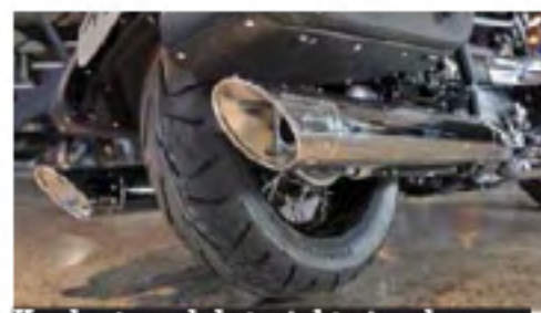
Knalpot model straight pipe dengan potongan menyamping di ujungnya
