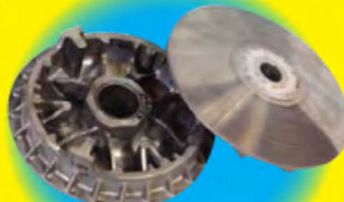
Sudut pulley diracik ulang dan jalur roller di kerok efeknya akselerasi dan top speed lebih baik
