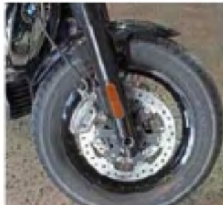
Roda depan R 18 Classic menggunakan lingkaran roda 16 inci dengan ban gambo
