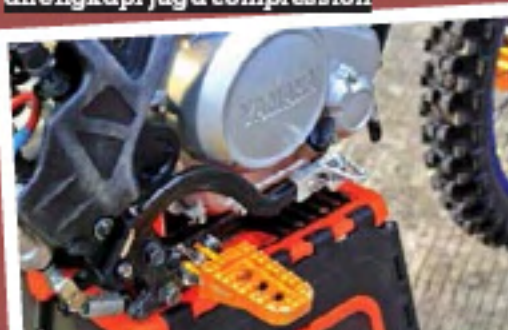
Footstep dan pedal rem ganti yang lebih kasar, agar kaki tidak mudah selip
