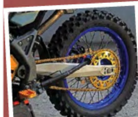
Final gear pakai 56/13 Scarlet Racing, bahan di atas baja jaminan kuat dan tampil mewah
