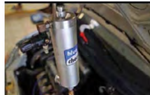
Saluran bahan bakar dipurging untuk bersihkan kerak yang ada di injector dan intake manifold
