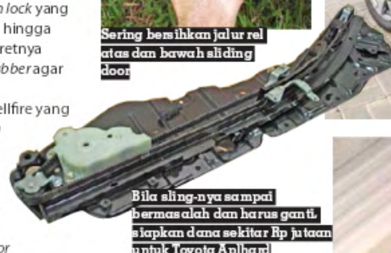
Perhatikan kebersihan dan setelan pintu, agar pintu geser tetap lancar buka-tutupnya
