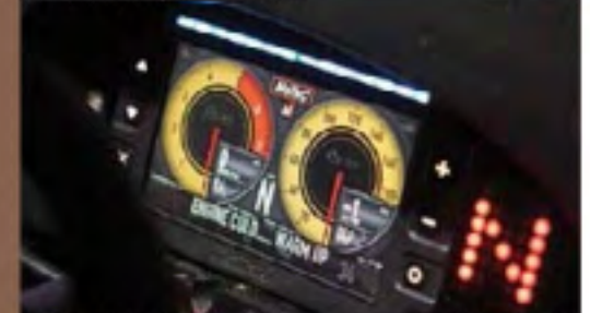
ECU Motec, display dash pakai Haltech. Ragam informasi lengkap terbaca
