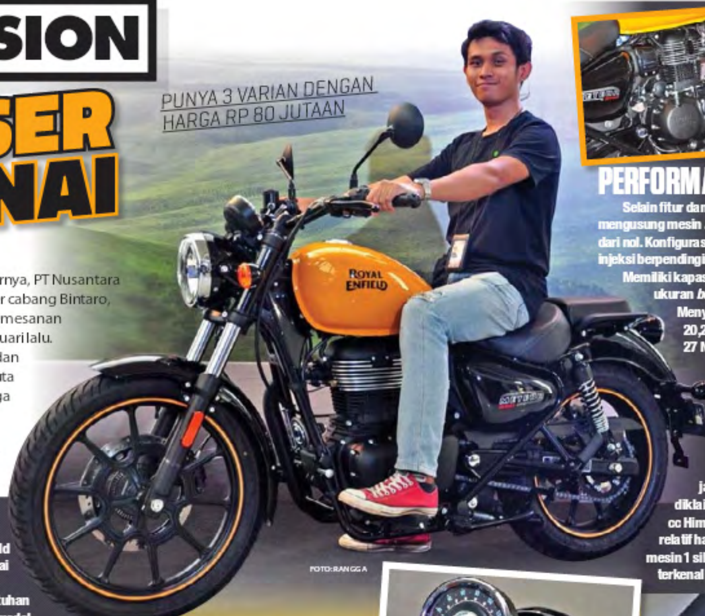
Mesin 350 cc 1 silinder all new yang diklaim minim getaran berkat balancer shaft
