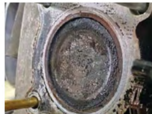
Terlihat di piston masih ada sisa kerak kecil di pinggir piston saja
