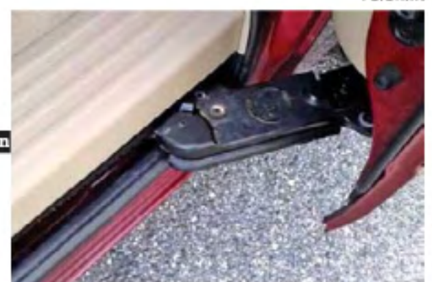
Jika jalur rel tidak lancar dapat merusak elektrikal dan sling-nya loh!
