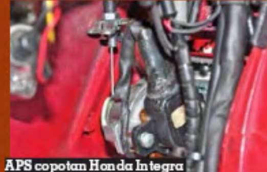
APS copotan Honda Integra masing menggunakan sling dan throttle bawaan Vespa Sprint
