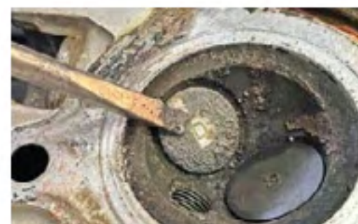
Di dalam ruang bakar masih tersisa sedikit kerak keras, kalau mau optimal perlu 2 atau 3 kali gurah nih
