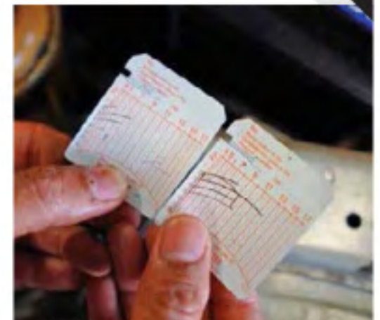
Ini dia hasil pengukuran kompresi mesin Aveo LT 2004, sebelum (kiri) vs sesudah mesinnya ditune up
