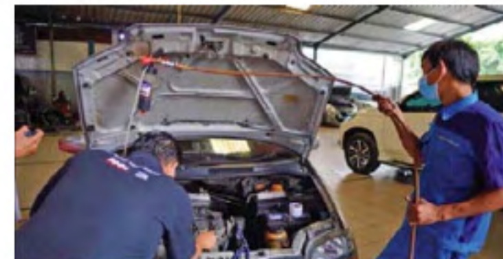
Semua silinder digurah menggunakan carbon cleaner keluaran Bluechem asal Jerman
