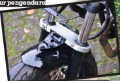
Braket sepator depan ikut ke stabilizer sokbreker
