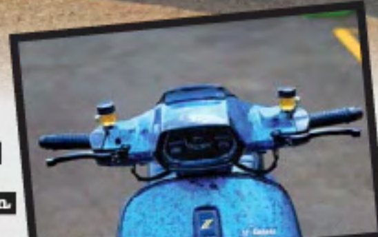
Master rem radial Adelin dirasa cukup, pemasangan perlu coak batok
