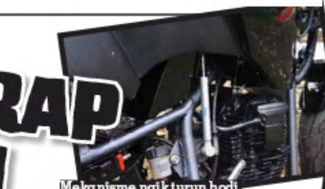
Mekanisme naik turun bodi menggunakan hidraulis yang dipasang di bagian dalam bodi dan sasis
